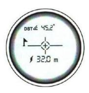
Режим захвата флагштока предназначен для измерения сигнальных мачт, опорных линий электропередач и других вытянутых объектов.
