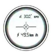
Непрерывное нажатие кнопки включения позволяет измерять скорость подвижных объектов, прибор фиксирует скорость с периодичностью 1 сек.
